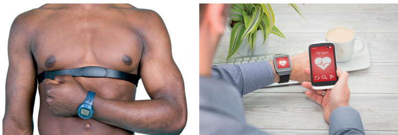
Figura 1.7 | Monitores de frequência cardíaca através de transmissor de peito (A) e através de luz infravermelha (B)
